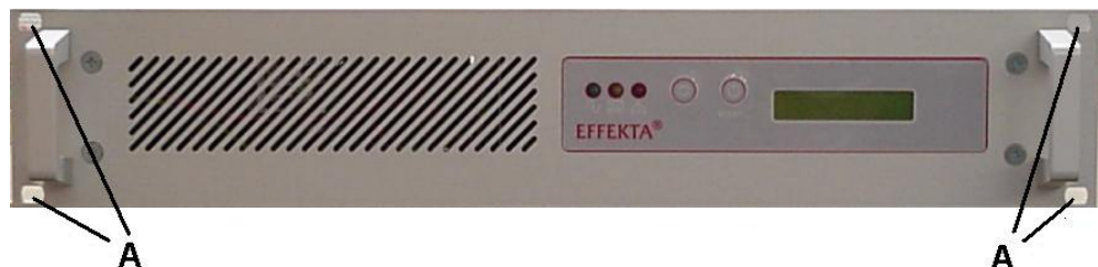
Abb. 4: Frontansicht, Darstellung der Einbaulage und der Befestigungspunkte
