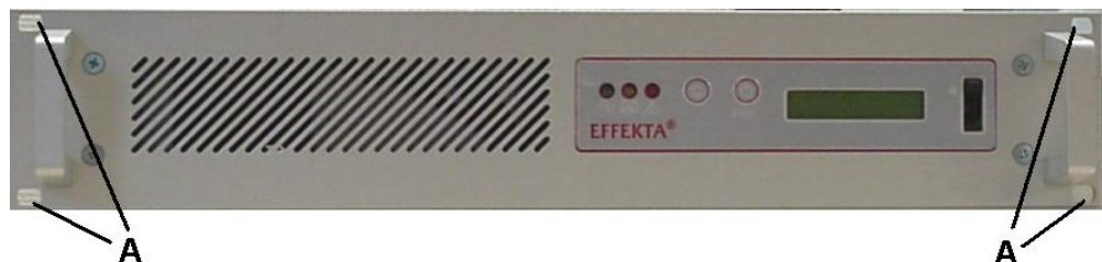
Abb. 4: Frontansicht, Darstellung der Einbaulage und der Befestigungspunkte
